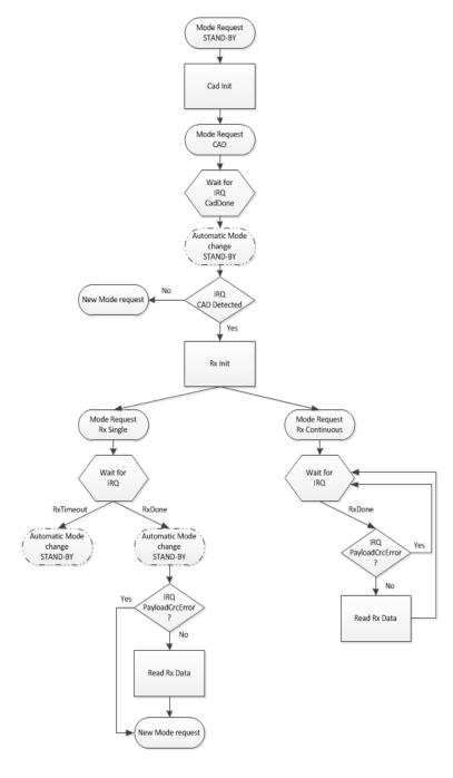
Figure 11. LoRa<sup>TM</sup> CAD Flow
