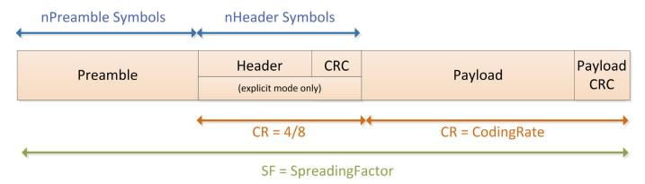
Figure 6. LoRa<sup>TM</sup> Packet Structure
