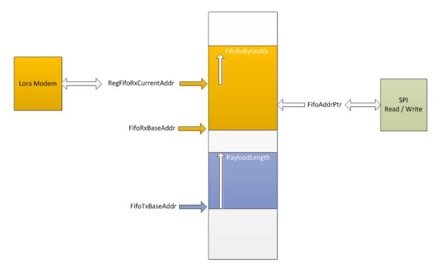
Figure 8. LoRa<sup>TM</sup> Data Buffer
