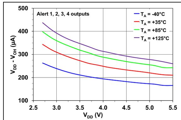
**FIGURE 2-24:** Alert Outputs,  $V_{OH}$  Across  $V_{DD}$ .
